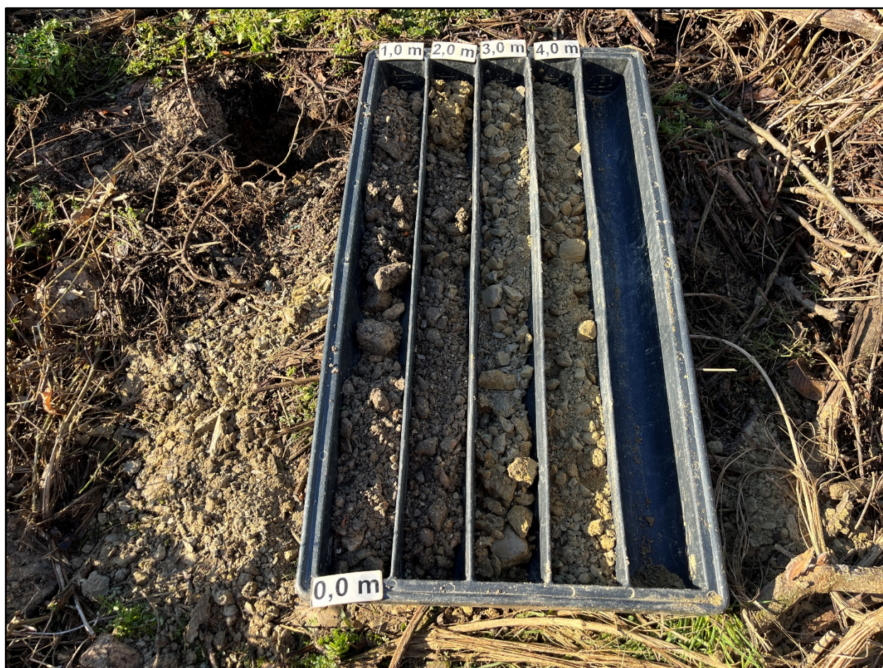
Slika 6. Prikaz jezgre temeljnog tla iz geotehničke istražne bušotine B-1
