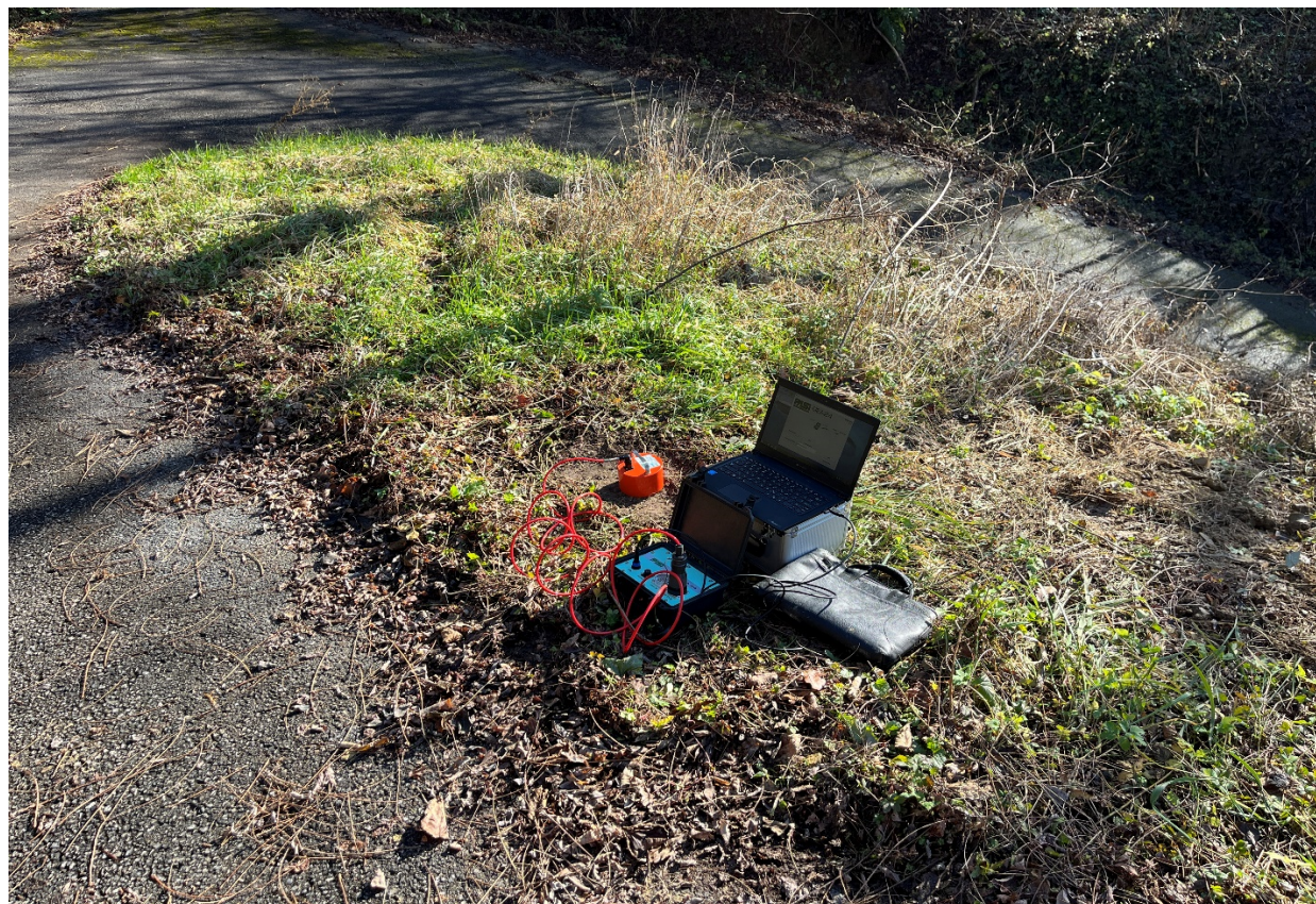
Slika 11. Prikaz načina i pozicije mjerenja seizmičkih karakteristika metodom HVRS
