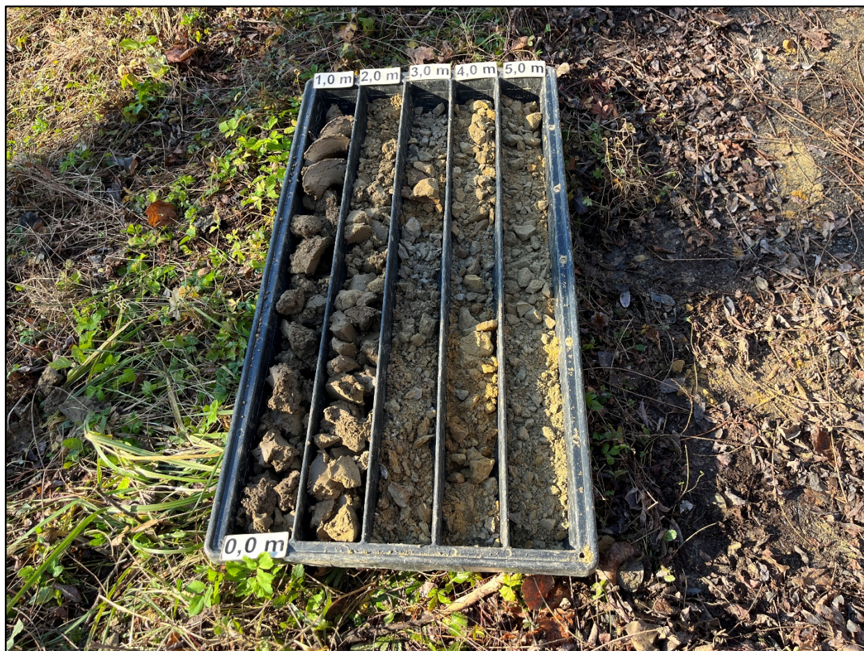
Slika 7. Prikaz jezgre temeljnog tla iz geotehničke istražne bušotine B-2
