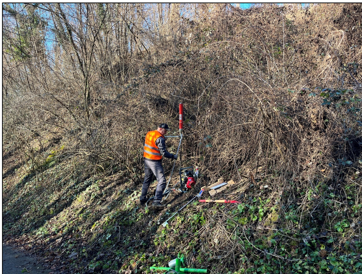
Slika 10. Prikaz ispitivanja lakom dinamičkom udarnom sondom (DPL-2)
